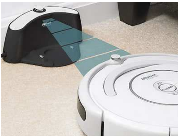
Obr. 13 Navádění robota pomocí paprsku do dokovací stanice. [10]
