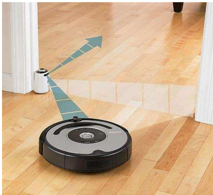
Obr. 12 Znáznornění vytvoření takzvané virtuální zdi. [11]
